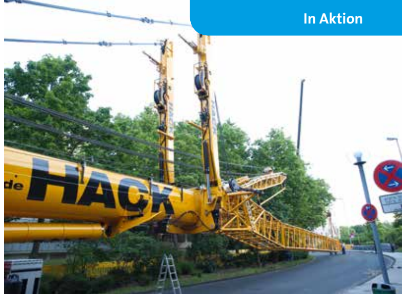
Die Schwierigkeit bei diesem Einsatz war, dass es nicht genügend Platz gab, die Wippe komplett am Boden zu montieren.
