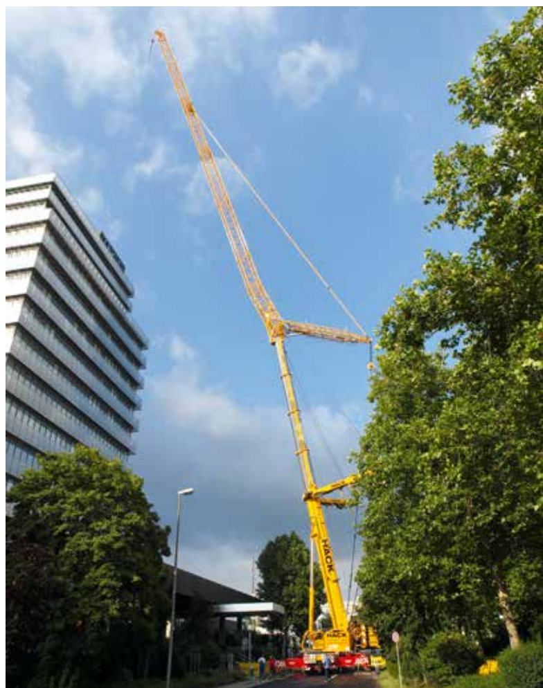
Die Schwierigkeit bei diesem Einsatz war, dass es nicht genügend Platz gab, die Wippe komplett am Boden zu montieren.
